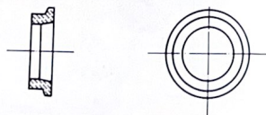
Fig. 7.8.—Fijación de la barra estabilizadora a los brazos oscilantes.
