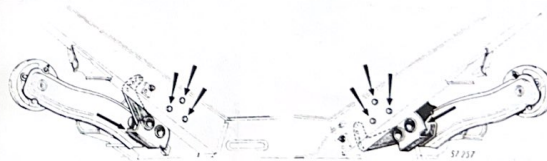
Fig. 6.1. Las flechas indican los tornillos que hay que aflojar para permitir el ajuste, de la convergencia en las ruedas traseras.
