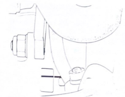
Fig. 9.15. Posición correcta de las marcas de puesta a punto del encendido en los motores tipo 813.
