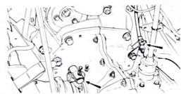
Fig. 1.7. La flecha de la derecha indica el soporte de la funda del cable del embrague.
