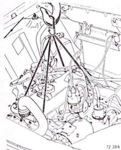
Fig. 12.—Colocación de los cables para extraerlos del motor.
