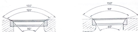
Fig. 1.10. Asientos de válvulas. A la izquierda, el asiento de la válvula de admisión y a la derecha, el de escape.
