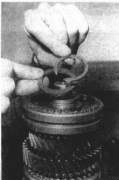
Desmontaje del aro de bloqueo y de la arandela del extremo del eje secundario.
