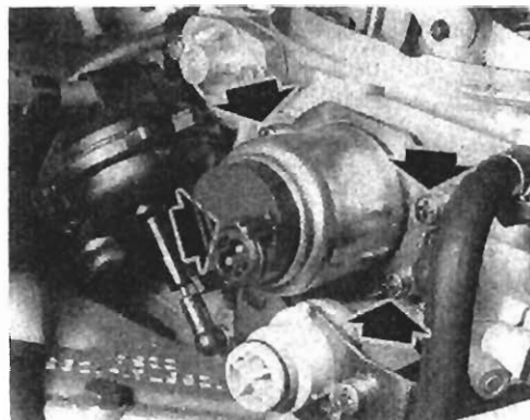
Desmontaje del servomotor del estrangulador.
