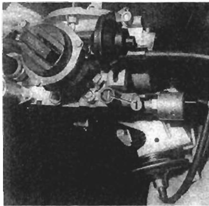
1. Tornillo de reglaje del ralentí.
