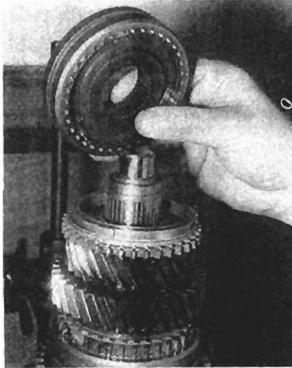
Colocación del sincronizador de 3ª y 4ª.
