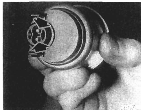
Controlar el servomotor conectando un ohmímetro a las clavijas del aparato
