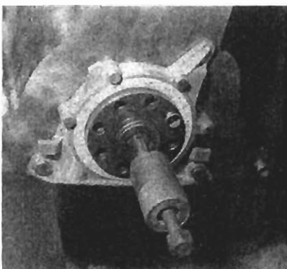
Extracción del cojinete de agujas del cigüeñal.
