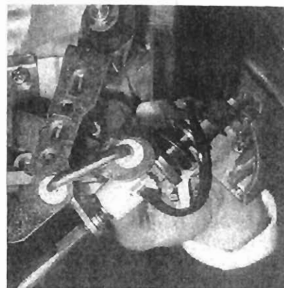
Para el reglaje de base del regulador, colocar un tornillo de reglaje nuevo.
