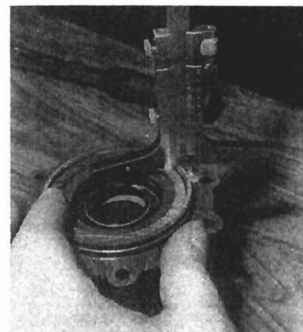
Medición de la distancia entre el plano de junta de la guía de cojinete y la arandela de reglaje instalada.
